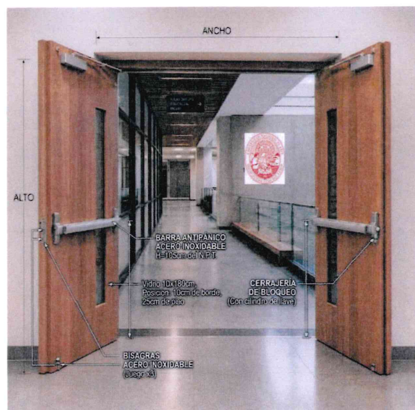
Elevacion Puerta Antipánico esc. 1:25
