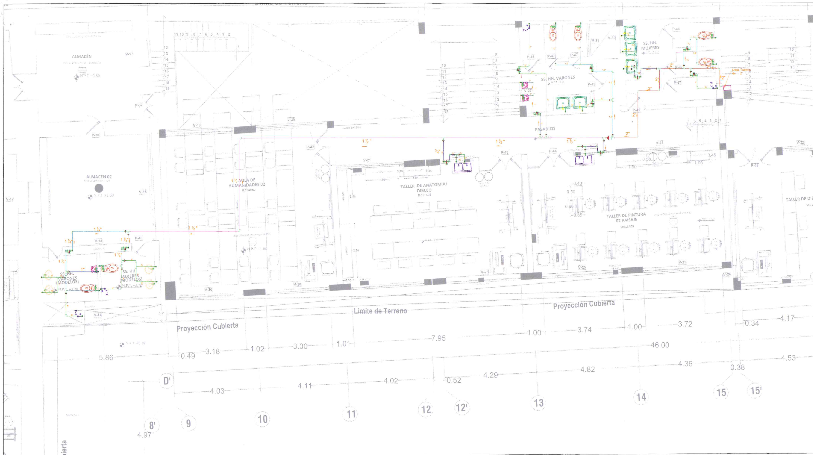
INSTALACIONES SANITARIAS DE AGUA SECTOR II SEGUNDO NIVEL ESC. 1:50
